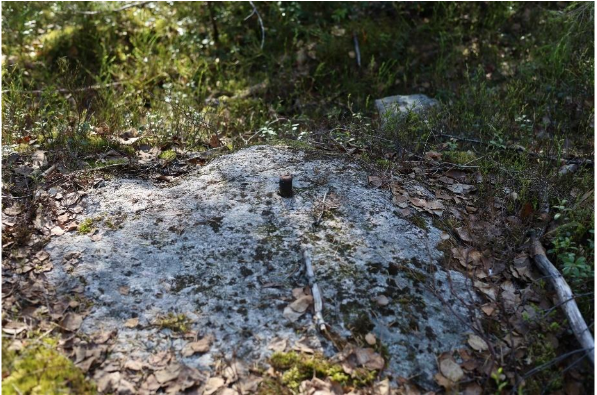
Kuva 3-19 Kuvassa on toinen Horrilankeron mittauspisteen läheisyydestä löytyneistä kallioon hakatuista rautapulteista.
