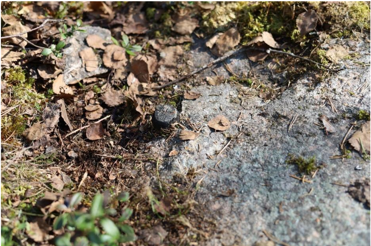
Kuva 3-20 Horrilankeron mittauspisteen läheisyydestä löytynyt kallioon hakattu rautapultti.
