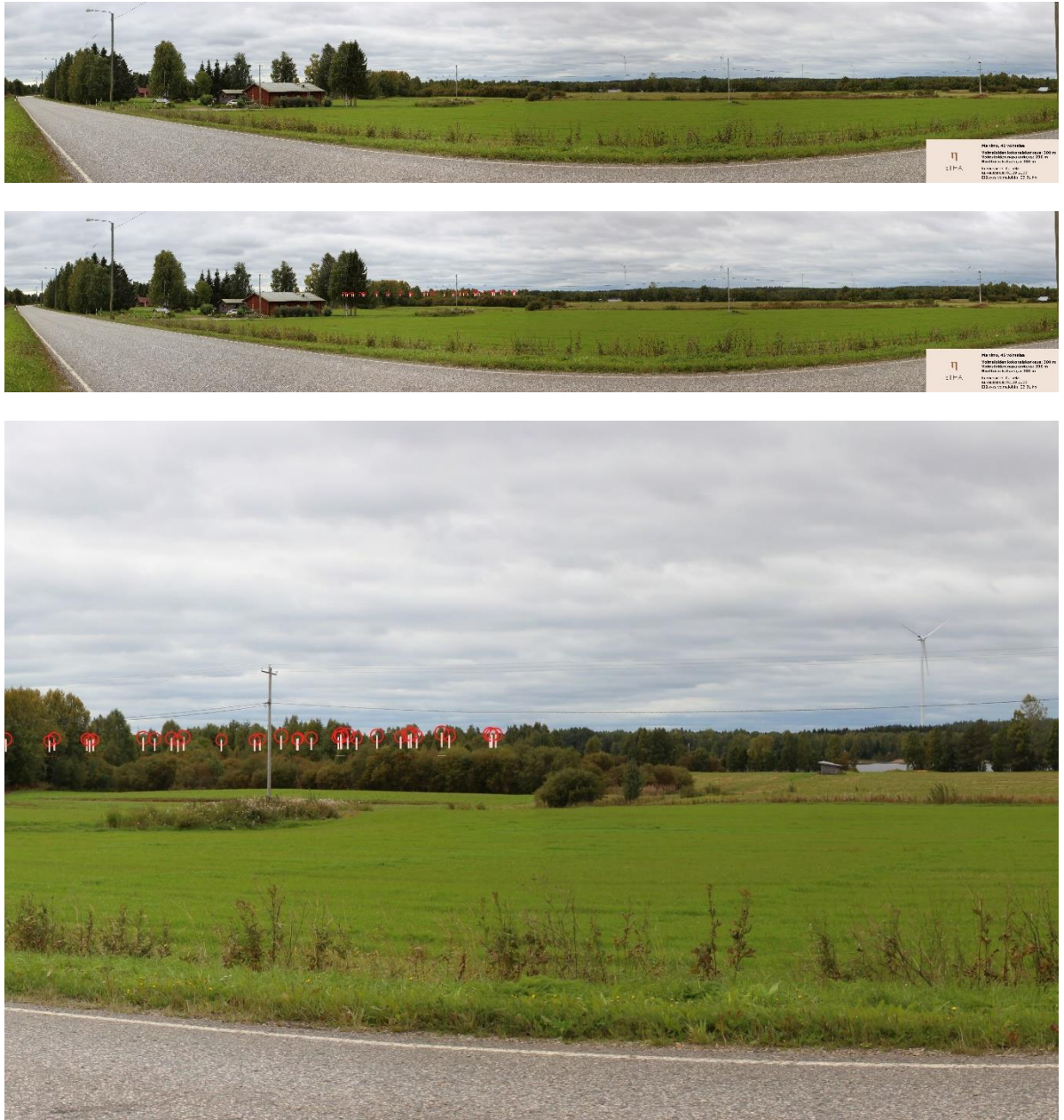
Kuva 10.18. Kaavaehdotuksen havainnekuva (yllä) Korpelan kylän kohdalta, Kemijoen itäpuolelta. Keskimmäisessä kuvassa on korostettu voimaloiden tornit valkoisilla viivoilla ja lapojen pyörimisalue punaisella ympyrällä. Alla oleva tarkennus vastaa noin 50 mm polttovälin objektilla otettua valokuvaa (todellisuudessa silmällä suunnilleen havaittava näkymä). Etäisyys kuvauspisteestä lähimpiin voimaloihin on noin 19,5–21,5 kilometriä. Suurempi osa voimaloista jää taustamaisemaan metsäalueiden taakse katveeseen etäisyyden takia. Tarkastelupisteestä riippuen myös kyläalueiden rakennukset ja pihojen puusto peittävät näkymiä. Näkyessään voimaloista on pääosin havaittavissa vain osa lavasta (alimmaisessa kuvassa voimajohtopylvään oikealla puolella). Maisemassa on myös nykyisiä tuotannossa olevia tuulivoimaloita, joiden rinnalle suunnitellut voimalat jäävät selvästi pienempinä elementteinä. Kuvauspisteessä tuulivoimaloilla ei ole vaikutusta maisemaan. Kuvauspäivä 3.9.2022.
