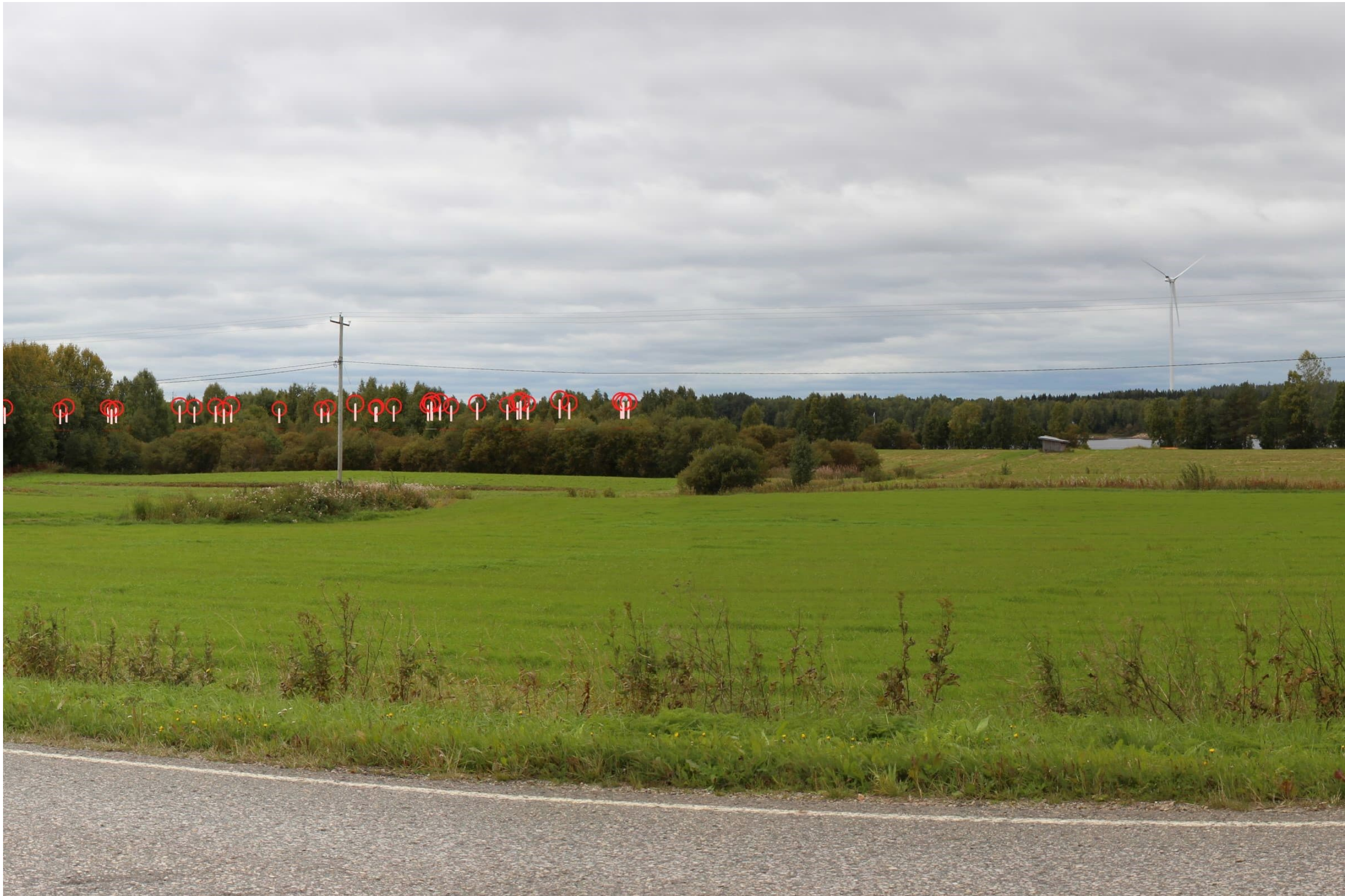
Kuva 8.4. Ihmiskatsetta (vaakatasossa 40 asteen kuvakulmaa) vastaava leike havainnekuvasta. Kuvassa on korostettu voimaloiden tornit valkoisilla viivoilla ja lapojen pyörimisalueet punaisilla ympyröillä.
