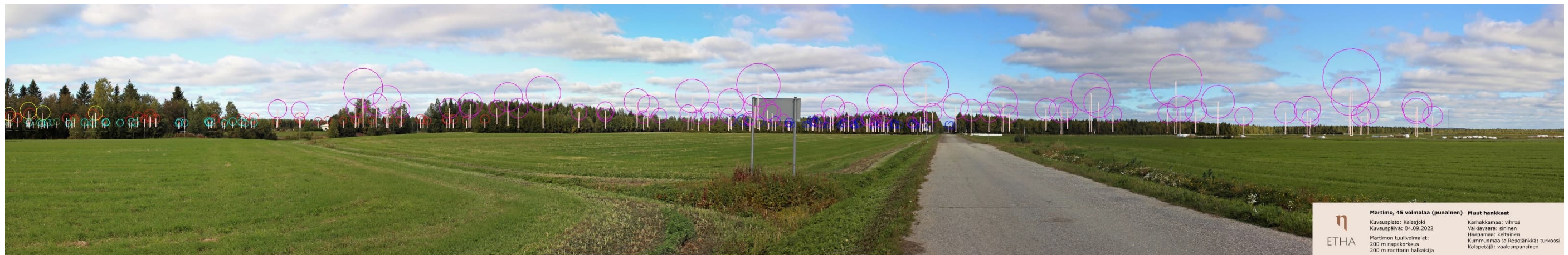
Kuva 4.6. Mallinnus tuulivoimaloiden sijainnista valokuvan päälle. Kuvassa on korostettu voimaloiden tornit valkoisilla viivoilla ja lapojen pyörimisalueet ympyröillä kuvan selitteen mukaisilla väreillä.
