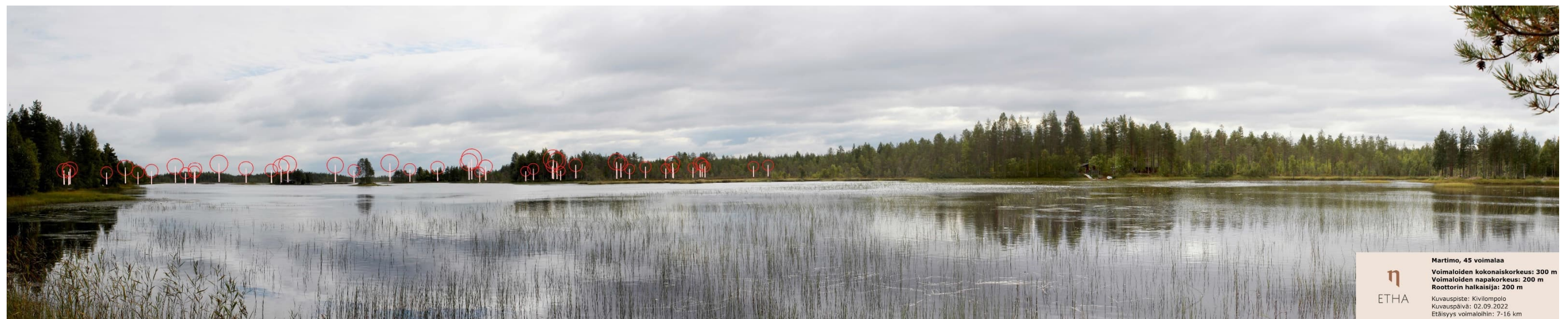
Kuva 3.3. Mallinnus tuulivoimaloiden sijainnista valokuvan päälle. Kuvassa on korostettu voimaloiden tornit valkoisilla viivoilla ja lapojen pyörimisalueet punaisilla ympyröillä.
