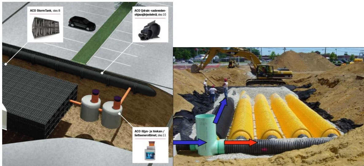
Kuva 14. Maanalainen viivytyksjärjestelmä (vasemmalla hulevesikasettikenttä, 5 oikealla putki/kammarikenttä 6 ).
