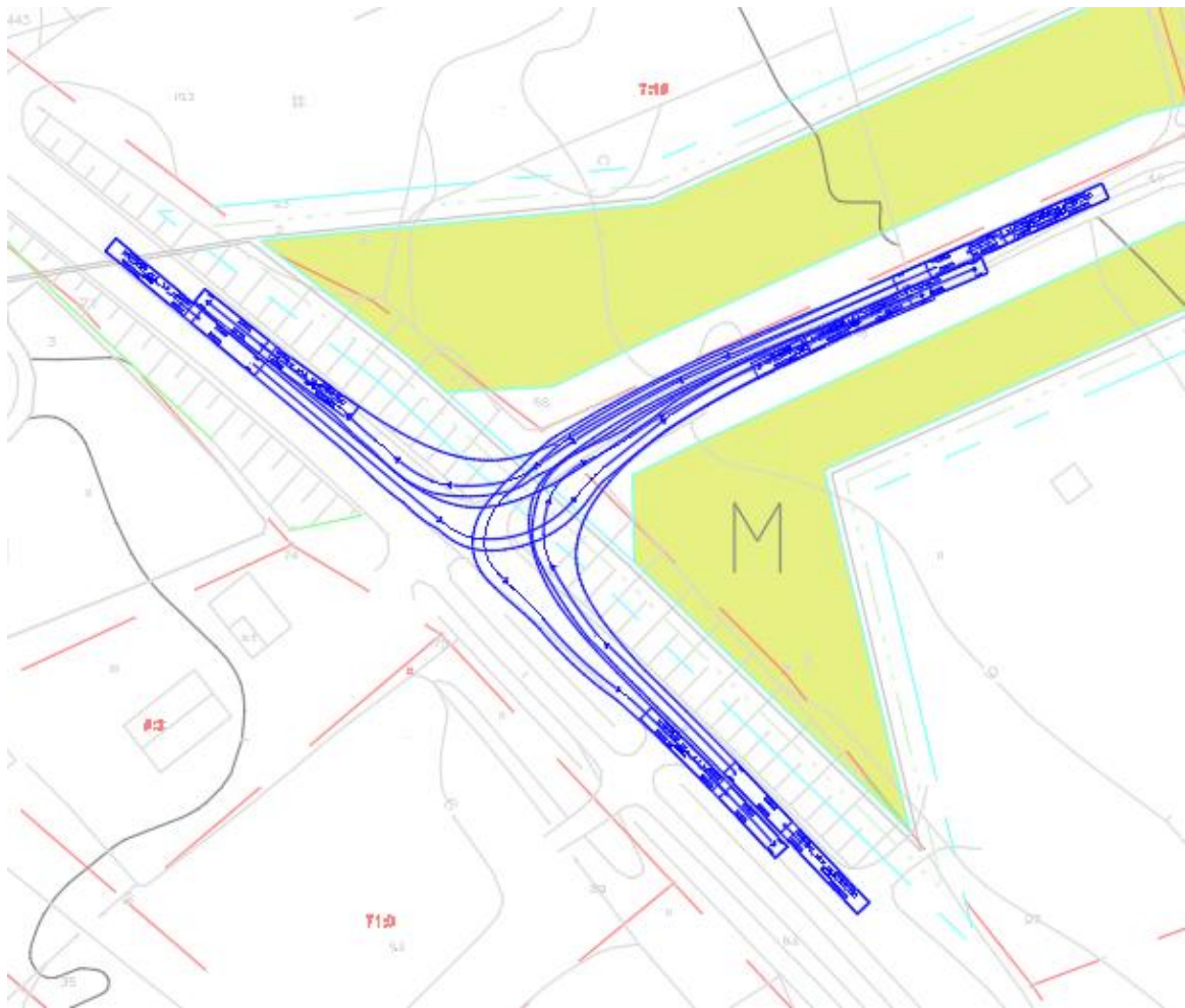
Kuva 8. Ajouratarkastelu, Liittymä Raumontielle.
